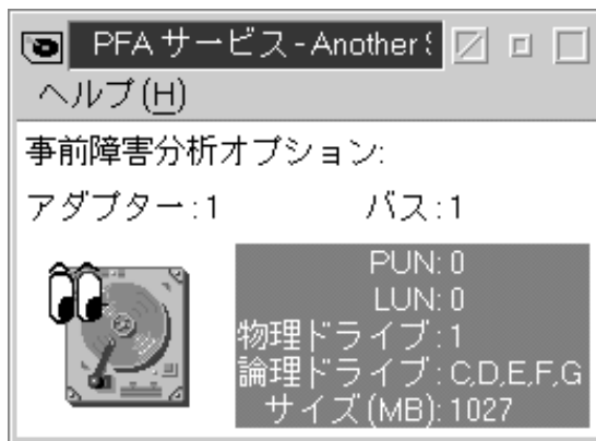
図 59. 「PFA サービス」。ここで示した PFA ドライブ・オブジェクトは、事前障害分析メッセージが報告されていないドライブを表しています。
